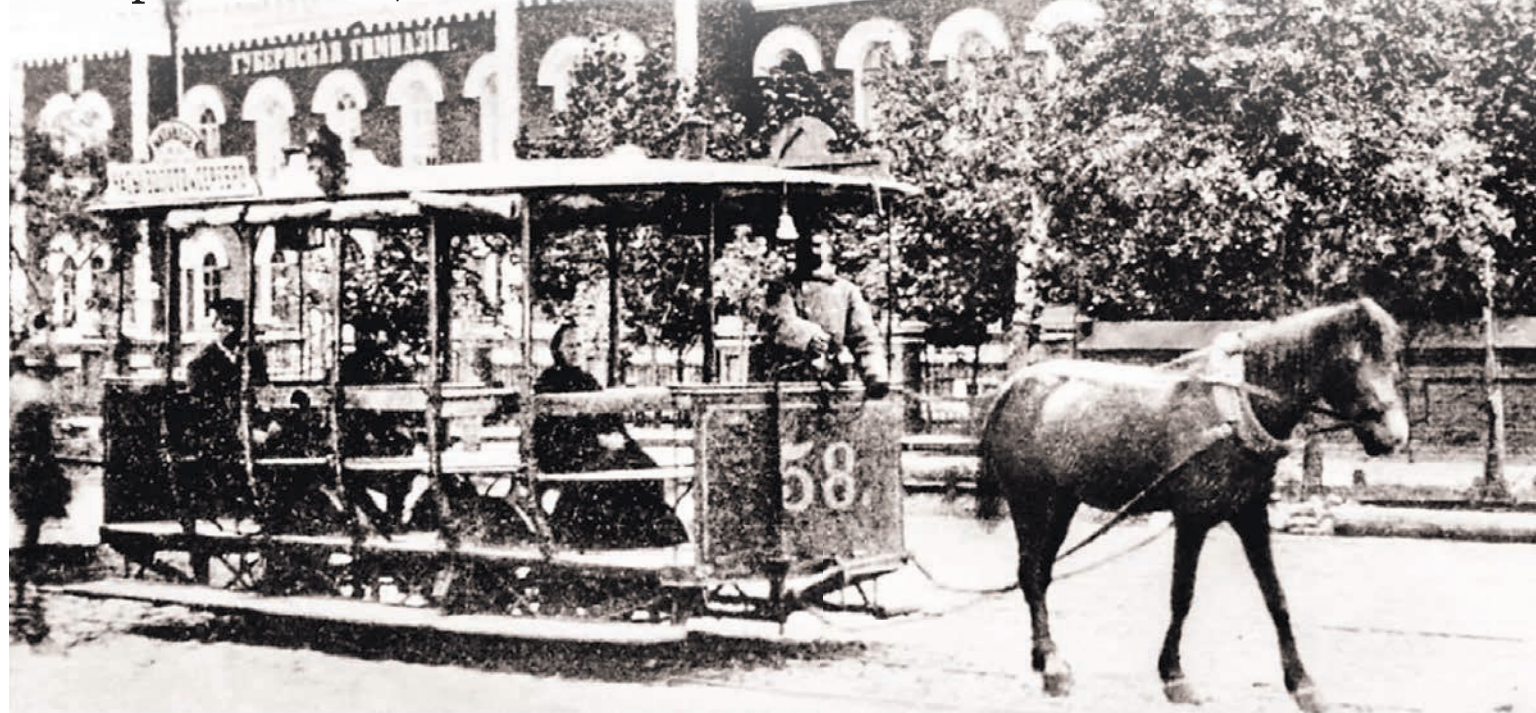
Вагоны воронежской конной железной дороги были рассчитаны на 20 пассажиров
