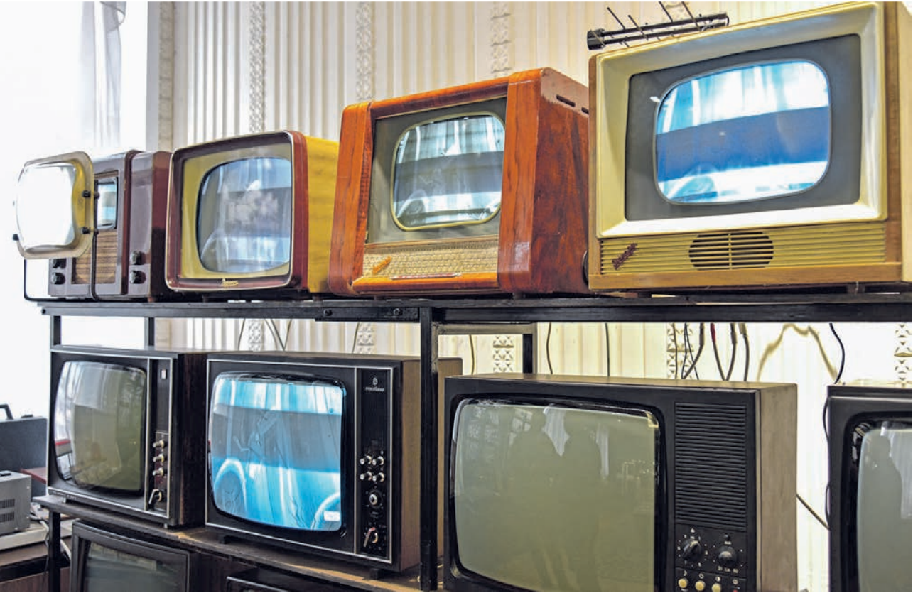
Воронежский завод производил десятки моделей телевизоров. А первым из них был чёрно-белый КВН-49 (на фото — в левом верхнем углу). Для увеличения изображения его оснащали наполненной водой линзой.
