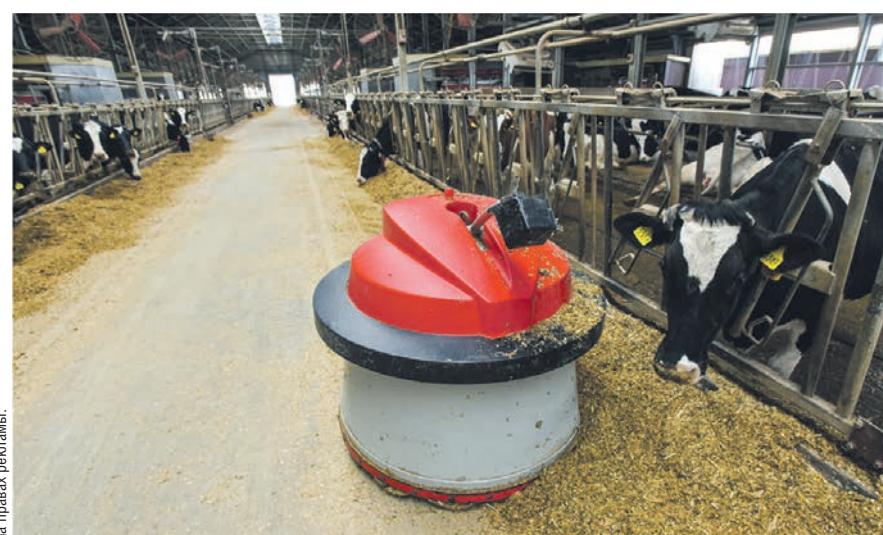
Многие процессы на предприятии автоматизированы, что позволяет значительно упростить и улучшить уход за животными (на фото слева — робот-подталкиватель, который подвигает рассыпанный корм ближе к животным)
